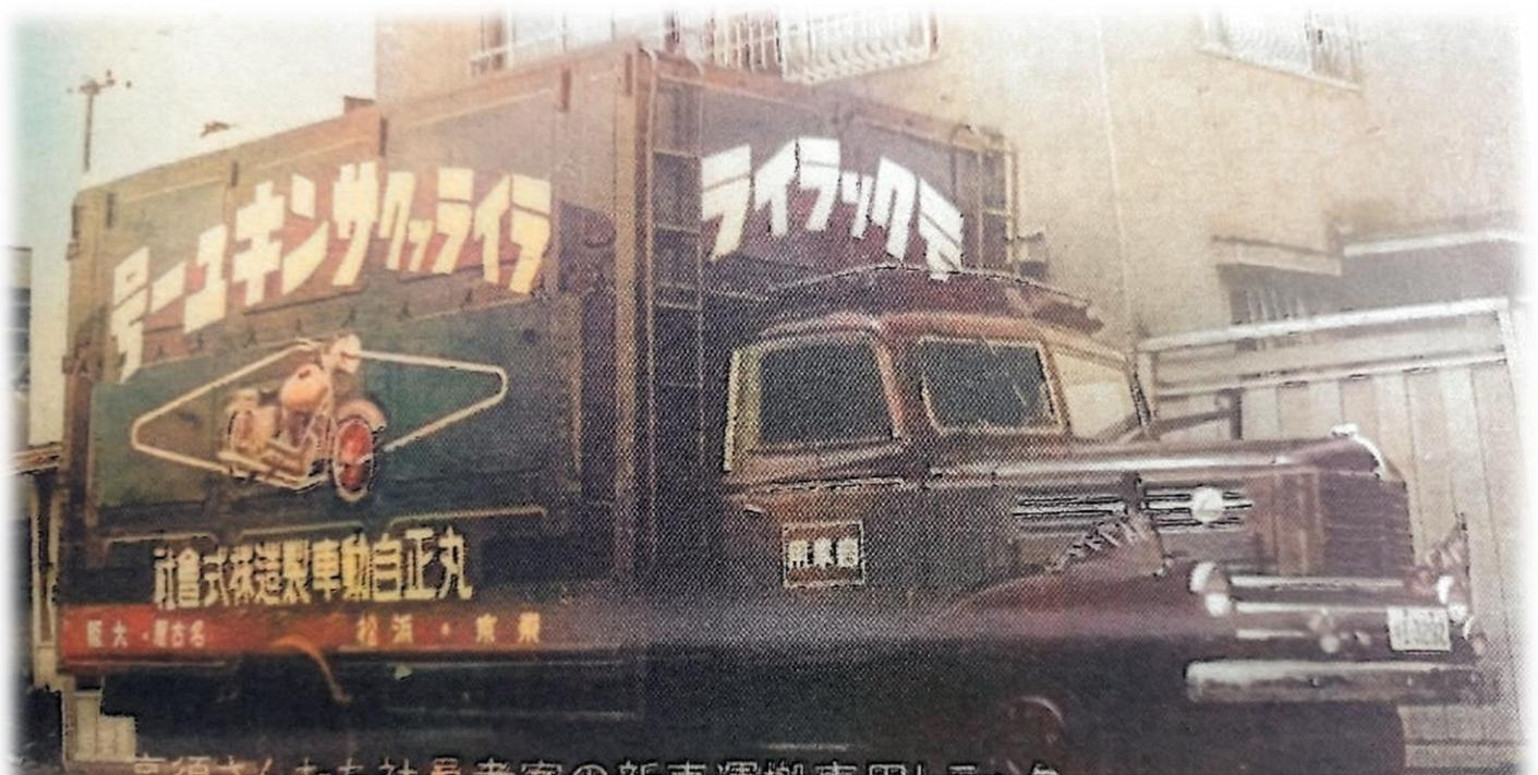
社員の考案オートバイ運搬トラック！後ろの荷台の内部は上下が2段となっており一度の運搬で12台が運べる作りだった。フロントタイヤのフェンダーカバーの揚羽蝶の羽の様にも見えるライラックの抜き文字文が見える風切が誇らしく、丸正の力強い時代を表している。自身を思い切り表現出来た時代だった。・・・陽射す、都大路を舞い踊るアゲハ蝶の様な勢いがある。
